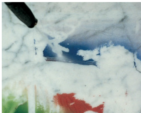
Nagynyomású vízsugaras tisztítás WallGard Graffiti Barrier-rel kezelt carrarai márványon
